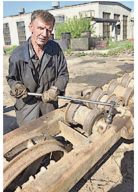
Полным ходом идёт ремонт ходовой части трактора Т-130! Анатолий Остапенко не подведёт!
